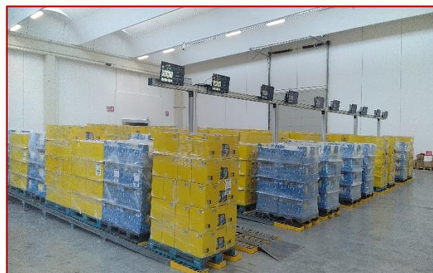
Мониторы, управляемые программным обеспечением WMS Cassioli и расположенные над каждым выходом гравитационных роликовых конвейеров, показывают всю информацию, касающуюся поддонов и выполняемого заказа. ПО WMS Cassioli также отвечает за управление ручным складом на земле, вместимостью около 6.000 поддонов, и его полную интеграцию с автоматическим складом.
