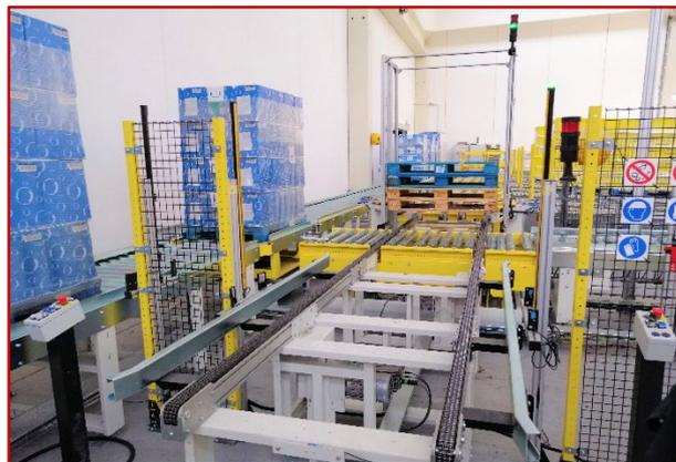
Вход и выход товаров со склада происходит на уровне 0 через систему обработки, состоящую из различных типов конвейеров. Входящие на склад поддоны (европоддоны или пары поддоны Düsseldorf) позиционируются через транспаллет в позиции загрузки: отсюда они проходят через двойную систему контроля, которая
