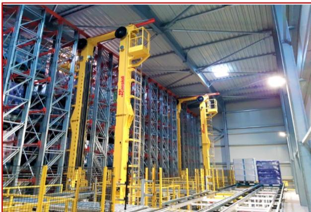
Cassioli планировал конструкцию автоматической системы хранения, состоящей из 3 кранов-штабелеров ICRANE с шаттлами ISAT для многоуровневого хранения. Каждый кран-штабелер обслуживает одну из трех частей склада, независимой для обеспечения доступа и технического обслуживания. Автоматический склад занимает общую площадь 2850 кв. метров при высоте 14,7 метра (6 из которых находятся под землей).
